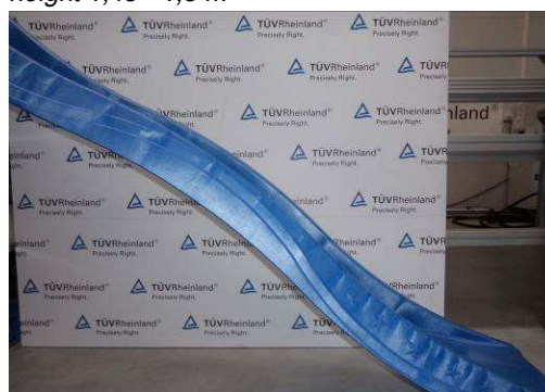
Fotografia / Photo 8 2_334_xxx HDPE wave slide for assembly height 1,45 - 1,5 m
